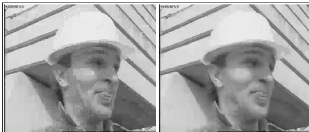
Figura 3 – Efeito do deblocking filter em H.264
