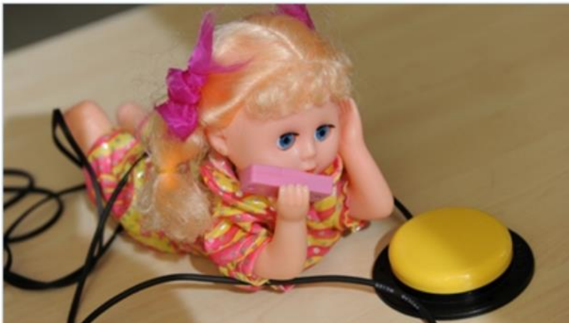
Figura 9 - Brinquedo adaptado ativado por Switch
