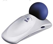
Estes dispositivos permitem aplicar as três direções em ações de rotação e translação usando a dimensão espacial XYZ (Vince, 2004).
